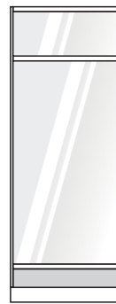
Modulo Mixto Paneles en Formica o Tapizados en Paño o Prana y vidrio de 4 mm
