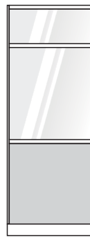
Modulo Mixto Paneles en Formica o Tapizados en Paño o Prana y vidrio de 4 mm
